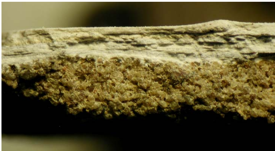
Statigrafie nátěrových a omítkových vrstev. Na snímku je patrná výrazná granulace cementové omítky (S231/2)
